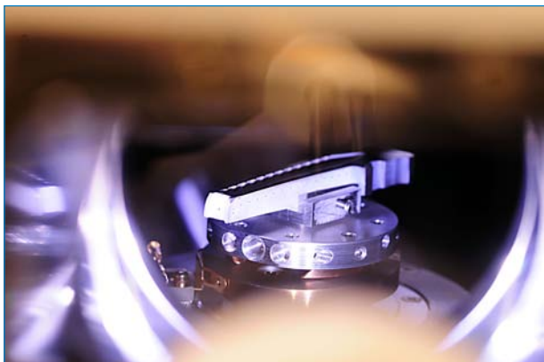
Aube de turbine, vue dans la chambre du MEB-FEG Zeiss Supra40.
